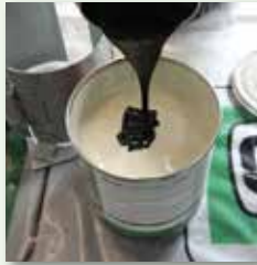
B-Komponente in die A-Komponente entleeren
